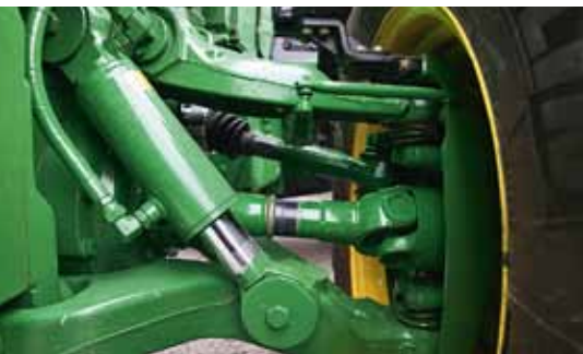
An der gefederten Einzelaufhängung erkennt man das neue Lenksystem nur an dem Gestänge für den Winkelsensor am oberen Lenker.
