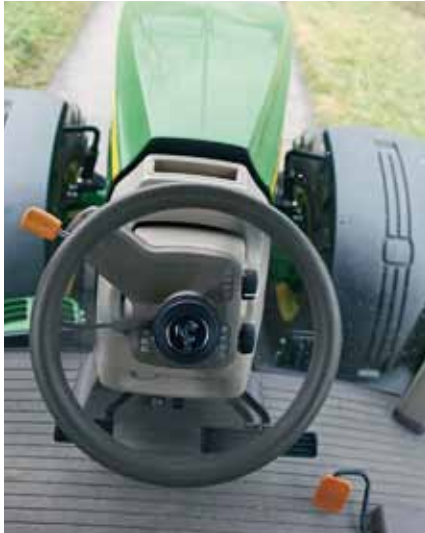
Ist der Motor aus, ist das kleine Lederlenkrad bei dem „Active Command Steering“ frei drehbar! Der Geradeauslauf der neuen Lenkung ist genial, die Sicht trotz der 400 PS unter der Haube sowieso.
