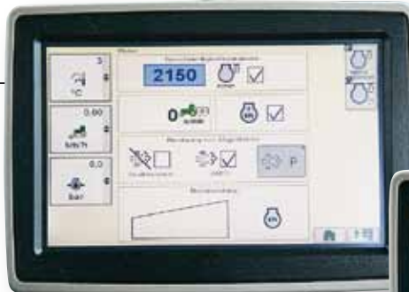
Das neue „GS3“-Display hat jetzt einen Touchscreen, und es gibt einen „Full Auto“-Modus für die Grenzlastregelung des stufenlosen Getriebes. Die Reinigung des Partikelfilters geht automatisch, wird dem Fahrer aber angezeigt und kann bei Bedarf deaktiviert werden.
