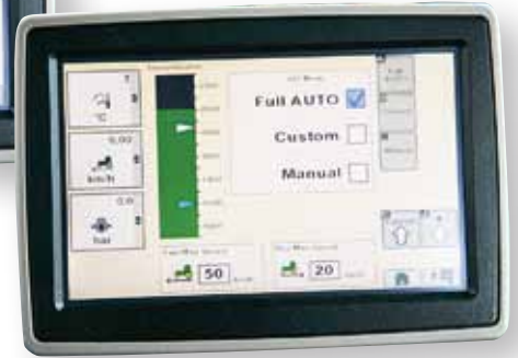
Das neue „GS3“-Display hat jetzt einen Touchscreen, und es gibt einen „Full Auto“-Modus für die Grenzlastregelung des stufenlosen Getriebes. Die Reinigung des Partikelfilters geht automatisch, wird dem Fahrer aber angezeigt und kann bei Bedarf deaktiviert werden.
