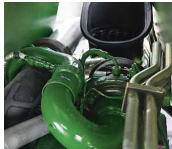
Oben auf dem Motor erkennt man die zwei Turbolader – einen mit fester und einen mit variabler Schaufelgeometrie.
