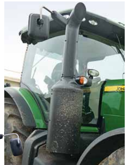
In dem dicken Auspuff sitzt der Oxidationskatalysator samt Partikelfilter. Da das System ohne AdBlue auskommt...
