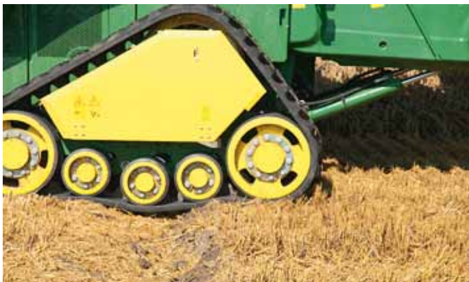
Dank Druckausgleich folgen die Tragrollen den Bodenunebenheiten.
