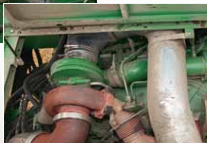
Seine Leistung entfaltet der DPS-Motor mit einem größeren variablen und einem kleineren Turbolader.
