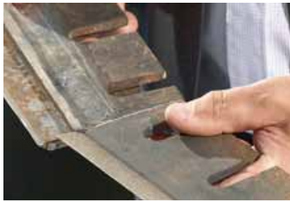
Maismesser neu und nach über 96 000 t sowie ein Grasmesser nach 32 000 t.
