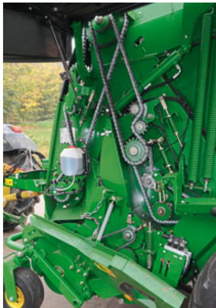
Der Antrieb ist an beiden Seiten (hier links) sehr überschaubar. Nur Aufkleber mit Einstellinformationen für die Kettenspannungen fehlen.
