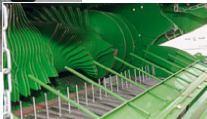
Die ungesteuerte Pickup mit Niederhalter und der Rotor bewältigen die Materialmengen, die die RB 990 schluckt, ohne Probleme.
