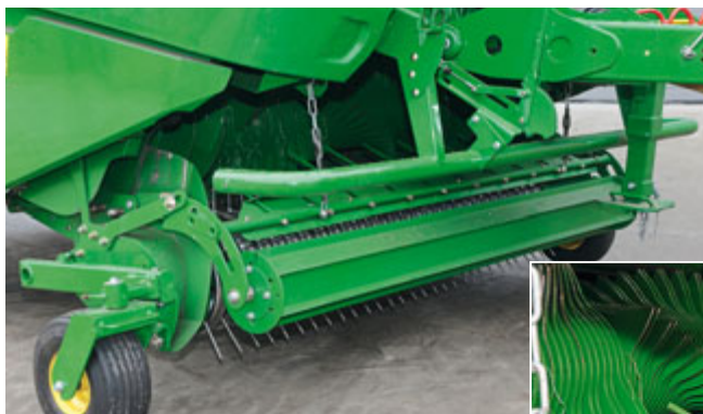
Die ungesteuerte Pickup mit Niederhalter und der Rotor bewältigen die Materialmengen, die die RB 990 schluckt, ohne Probleme.
