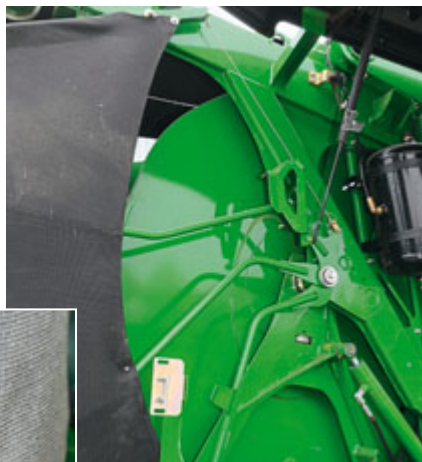
Der Vorhang wird über ein hydraulisch betätigtes Gestänge verschwenkt. Schäden oder Abrieb haben wir nach einer Saison nicht festgestellt.
