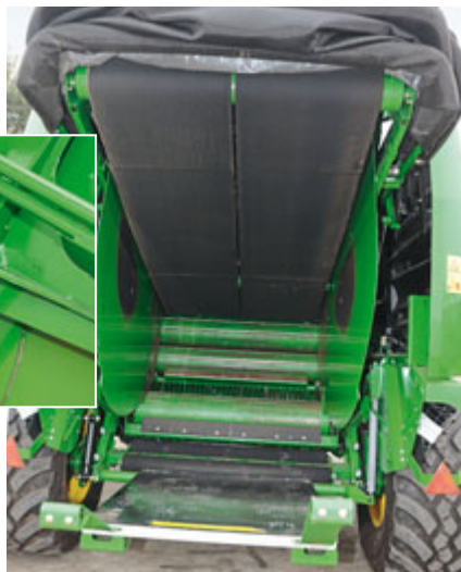
Die Presskammer hat drei Walzen und zwei breite Riemen. Die Bleche schwenken beim Entladen nach außen. Für die richtige Arbeitsposition sorgen eine Kulisse und eine Stahlrolle, die das Außenblech beim Absenken fixiert.
