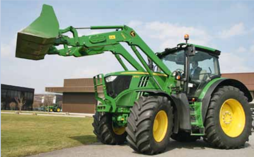
Der Frontlader H360 mit elektronischer Parallelführung an einem 6170R: Allein Sensoren bestimmen die Neigungswinkel, die elektrohydraulisch angesteuert werden.
