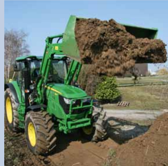
Lader mit mechanischer Parallelführung gibt es jetzt auch mit Positionsrückführung.
