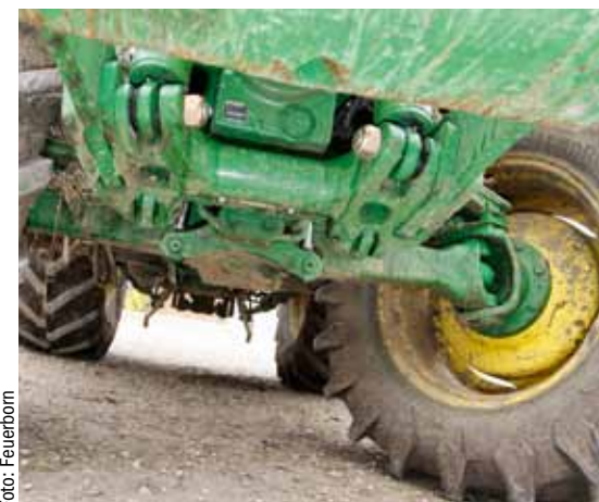
Die gefederte, niveauregulierte Vorderachse hat einen großen Lenkwinkel.
