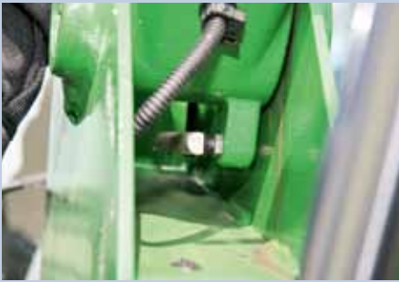
Sensoren überwachen die Winkel von Schaufel und Schwinge und steuern so die Hydraulik.
