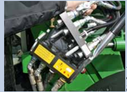
Elektrik und Hydraulik lassen sich mit dem Multikuppler auf einmal anschließen.
