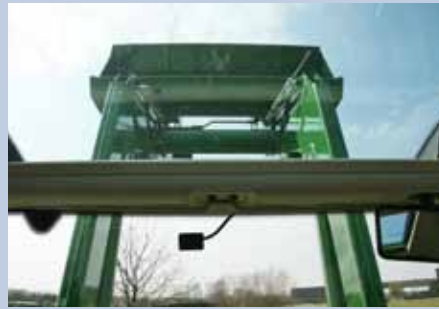
Die Sicht auf das Werkzeug ist dank Glasdach, verlagertem Querrohr des Laders und den innenliegenden Schläuche sehr gut.
