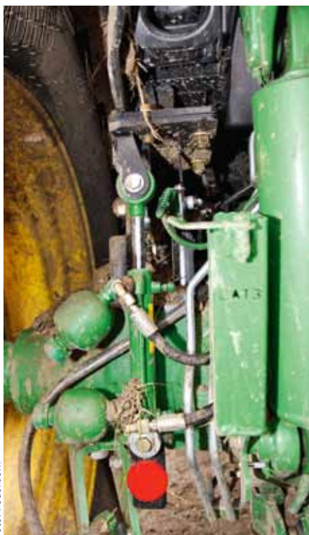
Die Kabine wird hinten hydropneumatisch gefedert und bietet guten Komfort.
