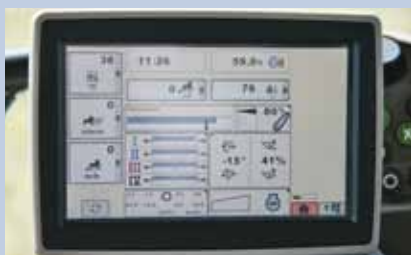
Alle Informationen für die Positionsrückführung oder die elektronische Parallelführung werden über das GreenStar 3 Terminal angezeigt. Die Einstellung erfolgt über Tasten oder Druck auf den Bildschirm. Das funktioniert einfach und schnell.
