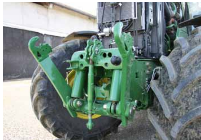
Der Frontkraftheber ist eine Eigenentwicklung und hebt bis zu 4 t. Er ist voll integriert und kann bei Bedarf auch nachgerüstet werden.
