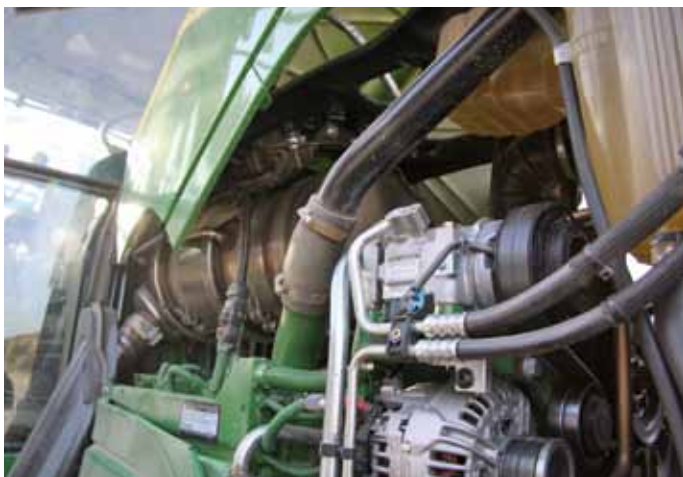
Der 6170M bleibt dem Nur-Diesel-Konzept von John Deere treu. Der selbstreinigende Dieselpartikelfilter sitzt unter der Motorhaube.
