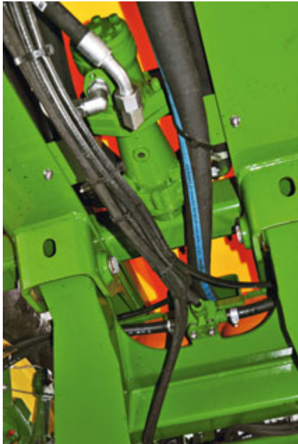
Die Pumpe unter der Spritze fördert bei beiden Verfahren das Klarwasser.
