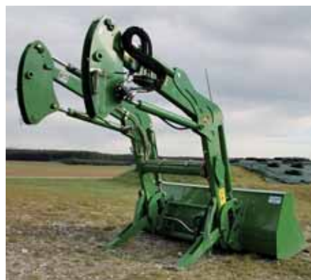
Die Schwinge mit hydraulischer Parallelführung hat die Hydraulikleitungen innen verlegt. Die Schmiernippel liegen außen
