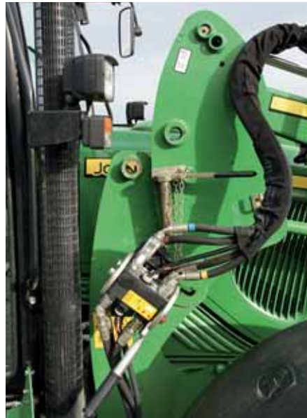
Gekoppelt wird mit Bolzen. Empfehlenswert ist der Multikuppler.
