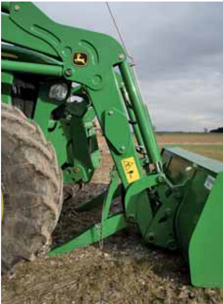
Die Abstellstützen verriegeln selbsttätig und müssen nur gesichert werden.
