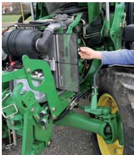
Das Kühlergitter kann ausgeschoben werden, das feine Sieb erleichtert die Reinigung.
