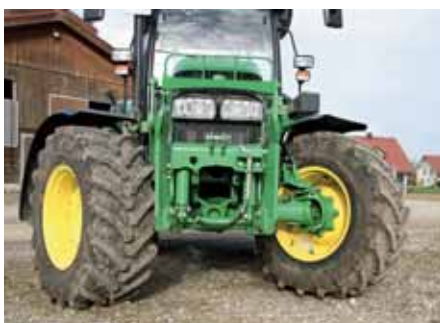
42 kN im Heck und 29 kN in der Front stehen als Hubkraft zur Verfügung, das reicht aus. Ein kurzer Radstand und 52 Grad Lenkwinkel machen den 5100 R zum Wendigsten in seiner Klasse mit 3,80 m Wenderadius.
