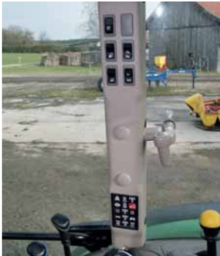
Die Arbeitsscheinwerfer werden an der B-Säule eingeschaltet.
